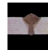
Материал 09Г2С Толщина 8 мм Скорость сварки 1,5 м/мин
