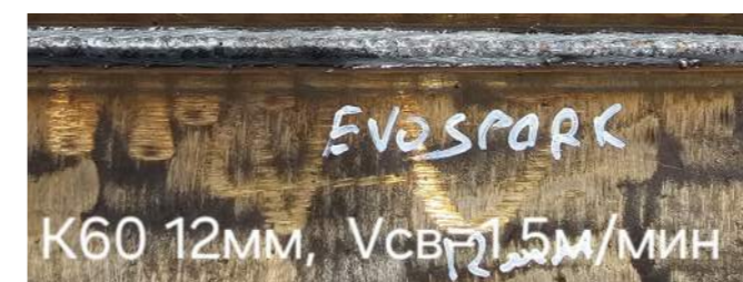
Сварка лазером и одним источником для стыкового соединения
