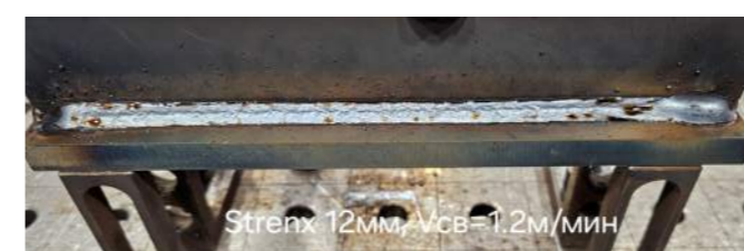
Сварка лазером и двумя источниками в одну сварочную ванну для таврового соединения
