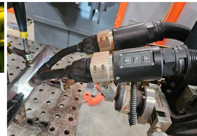
Комплекс гибридной лазерно-дуговой сварки, разработанный совместно с НТО «ИРЭ ПЛЮС»
